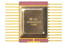
Используется для создания устройств высоковольтной гальванической развязки передаваемых сигналов с использованием внешнего импульсного трансформатора.
