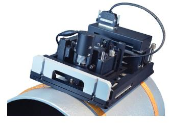
Комплекс позволяет диагностировать состояние конструкционных материалов на стадиях, когда традиционно используемые методы диагностики (например, ультразвуковая диагностика, оптическая диагностика и т.д.) еще не позволяют детектировать изменения состояния объектов промышленных конструкций. Это дает возможность прогнозировать остаточный ресурс промышленного оборудования, тем самым сводя к минимуму риски, связанные с экстренными отказами оборудования.
