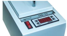
гревательный блок закрывается сверху защитной крышкой. Установка температуры нагрева производится с помощью кнопок, расположенных на панели дисплея.
