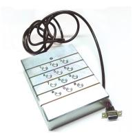
БИЖ-002 [жетон], и им подобными) с несущей частотой 13,56 МГц. Распознавание типа идентификатора – автоматическое.
