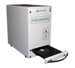
воды, воздуха, почвы, лесоматериалов, строительных материалов и других техногенных сред и объектов окружающей среды. «МУЛЬТИРАД-АР» предназначен для измерений активности и удельной активности альфа-излучающих радионуклидов в специально приготовленных образцах продуктов питания, кормов для сельскохозяйственных животных, воды, воздуха, почвы, лесоматериалов, строительных материалов и других техногенных сред и объектов окружающей среды.
